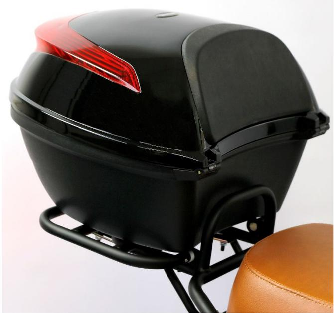
Befestigen Sie das Topcase an den hinteren Rahmen des Fahrzeugs mit den mitgelieferten Schrauben und Muttern.
