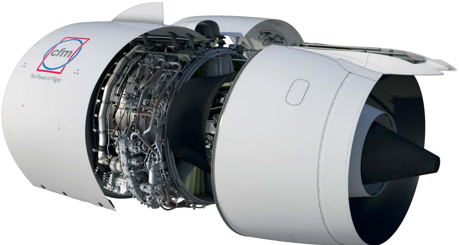
*LEAP-Turbine mit konifizierter Schubdüse*
