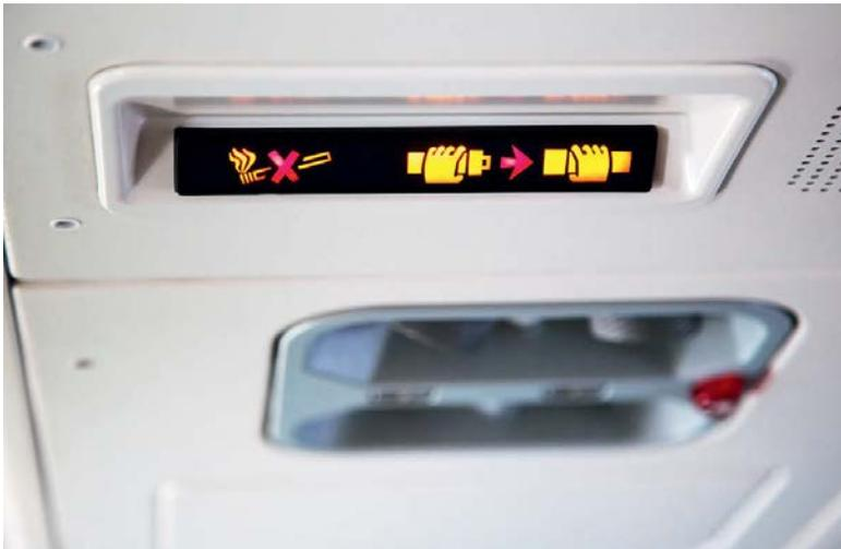
*Geht das Licht mit der Aufforderung zum Anlegen des Sicherheitsgurts an, wird das Signal von einem akustischen Ping begleitet*
