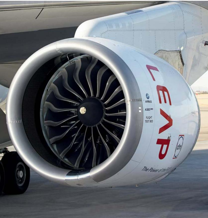
Ein LEAP-Mantelstromtriebwerk – hier zu Testzwecken – an einer Boeing 747-400
