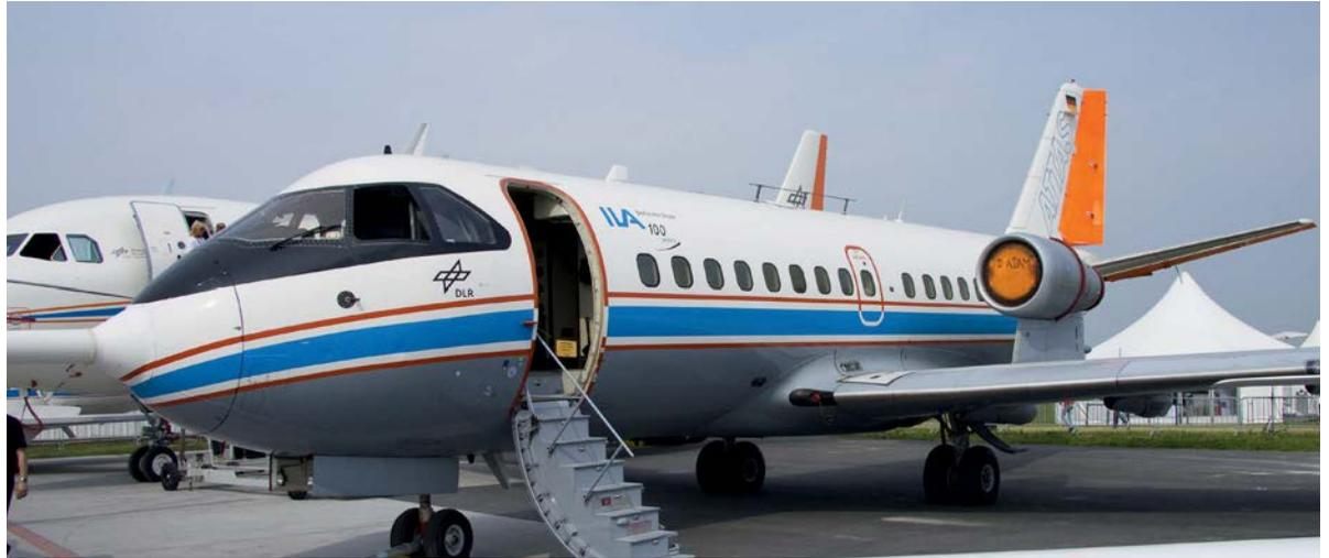
*Eine deutsche VFW 614 mit auf den Tragflächen montierten Triebwerken*
