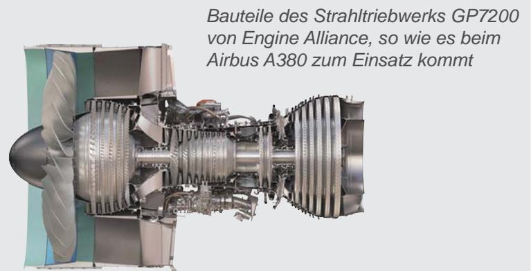
*Bauteile des Strahltriebwerks GP720 von Engine Alliance, so wie es beim Airbus A380 zum Einsatz kommt*
