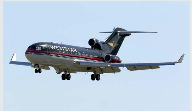
*Die Boeing 727 besitzt drei am und im Heck montierte Strahltriebwerke*
