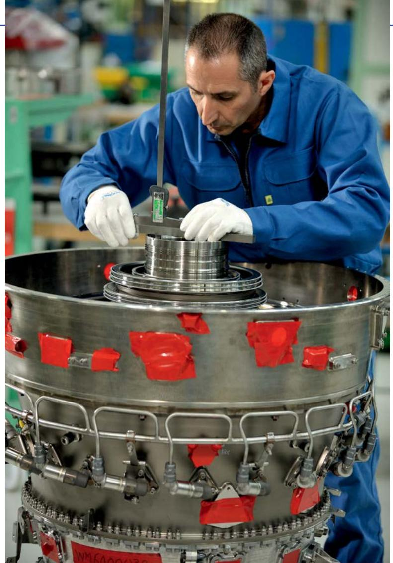
Montage einer Hochdruck-Turbineneinheit eines Strahltriebwerks
