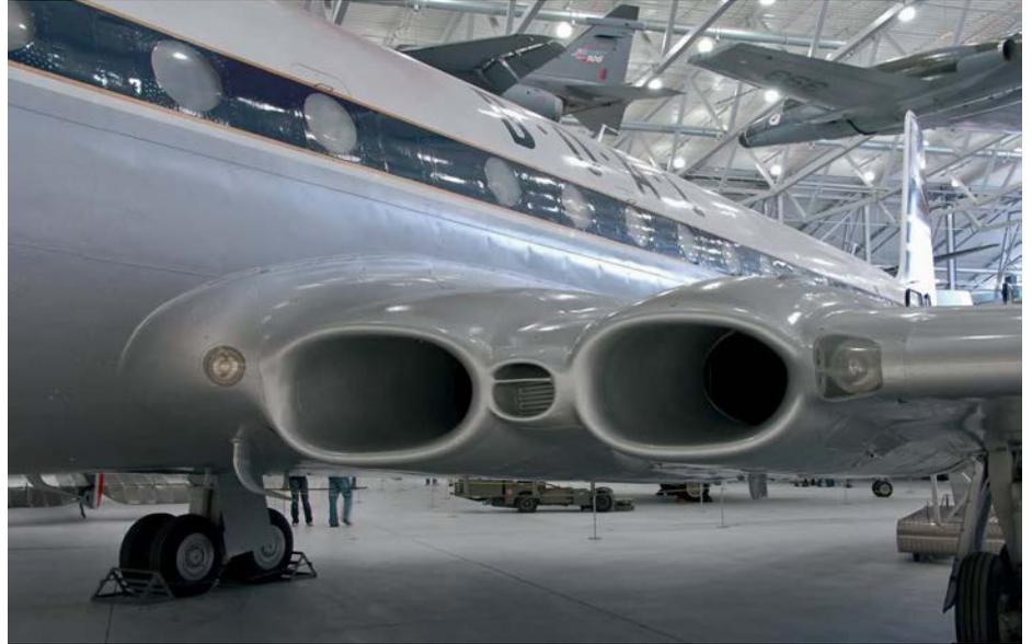
*Bei der DeHavilland Comet sind die Strahltriebwerke in den Tragflächen eingebaut*
