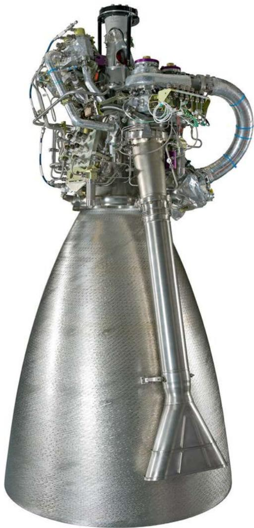
*Dieses HM7B-Raketentriebwerk kommt in den Raketen Ariane 4 und 5 zum Einsatz*
