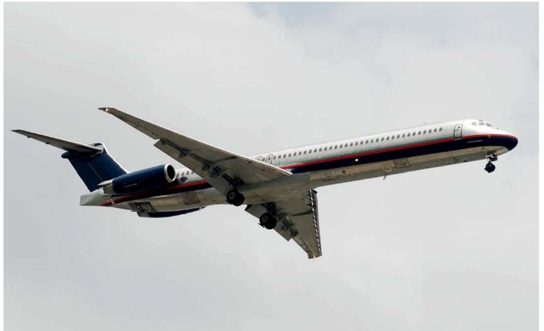
*Die Douglas DC-9 verfügt über zwei in der so genannten Tail-mounted-Bauweise links und rechts am Heck angebrachte Strahltriebwerke*
