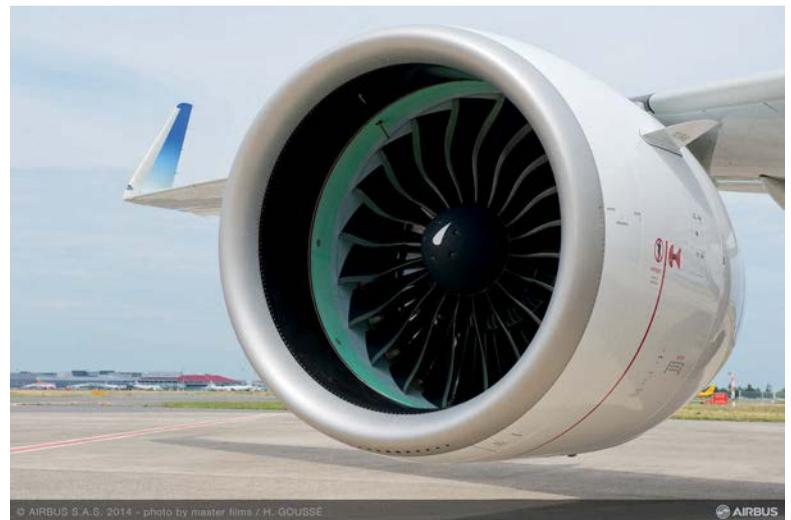
*Ein Pratt & Whitney PW1100G-JM-Triebwerk an einem Airbus A320neo*
