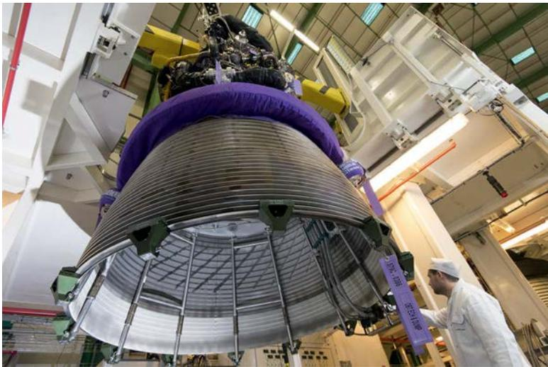
*Raketentriebwerk des Typs Vulcain 2 von Safran. Es wird seit 2005 in die Ariane 5 eingebaut*
