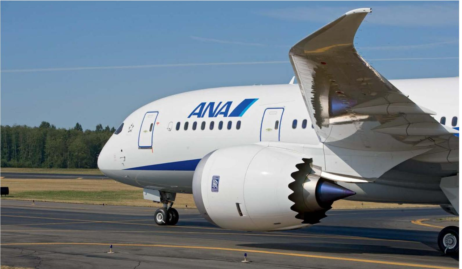
*Ein so genannter Chevron-Kragen mit Zackenmuster soll zu einer besseren Vermischung der vergleichsweise kühlen, langsamen Luft des Mantelstroms und der heißen, schnellen Gase aus der Düse beitragen*
