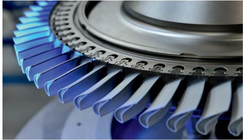
*Turbinenrad eines Zweiwellen-Strahltriebwerks SaM146 von Safran*
