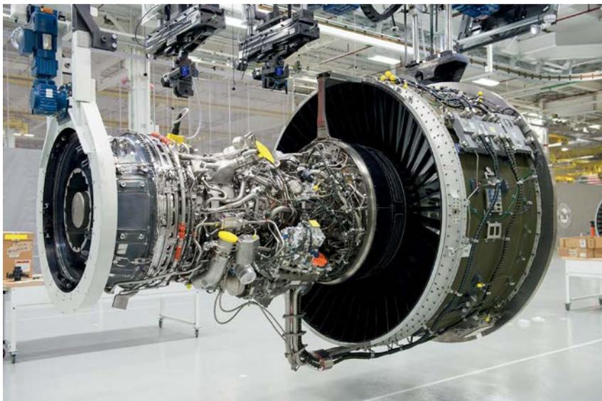
Teilweise demontiertes Turbofan-Triebwerk des Typs PW1100G-JM von Pratt & Whitney
