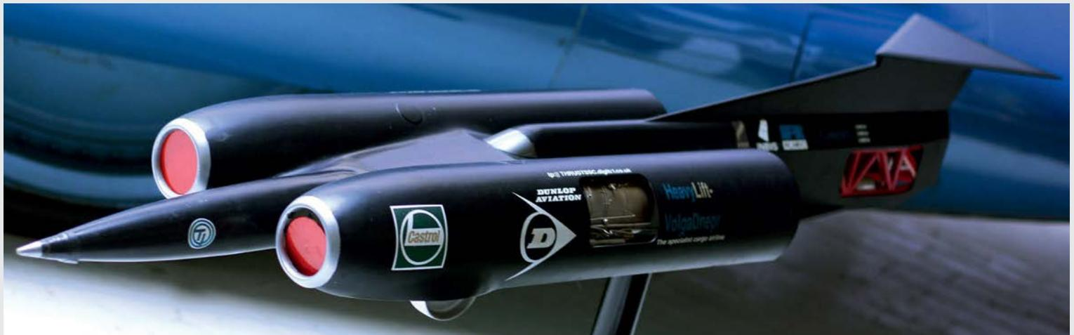
*Modell des Thrust SSC mit den beiden Strahltriebwerken. Das Super Sonic Car war das erste Landfahrzeug, das die Schallmauer durchbrochen hat*
