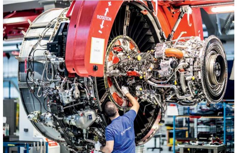
Endmontage eines Triebwerks des Typs LEAP von Safran
