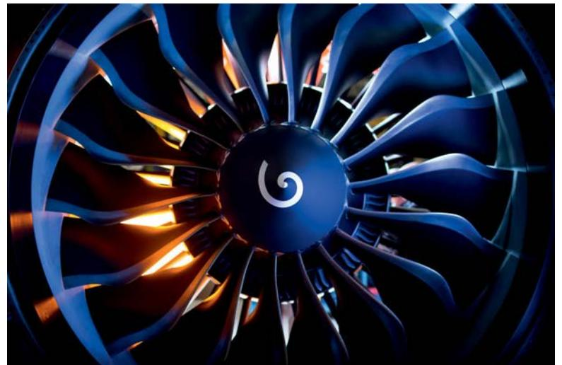
Der Fan (auch Bläser oder Schaufelrad genannt) eines Mantelstrom-Strahltriebwerks des Typs LEAP von Safran
