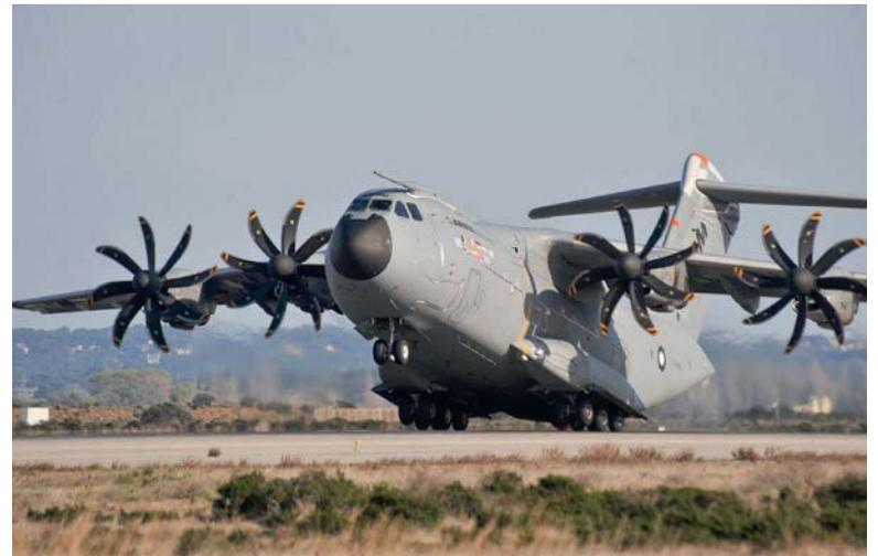
Die Militär-Maschine Airbus A400M wird von vier Turboprop-Triebwerken angetrieben. Damit lässt sich auch besonders langsam fliegen
