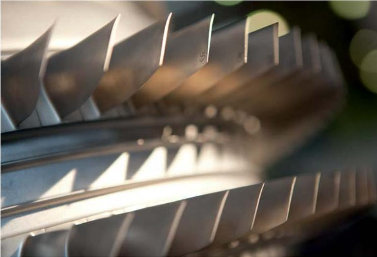
Rotor-Schaufeln des Niederdruck-Kompressors des Zweiwellen-Strahltriebwerks SaM146 von Safran
